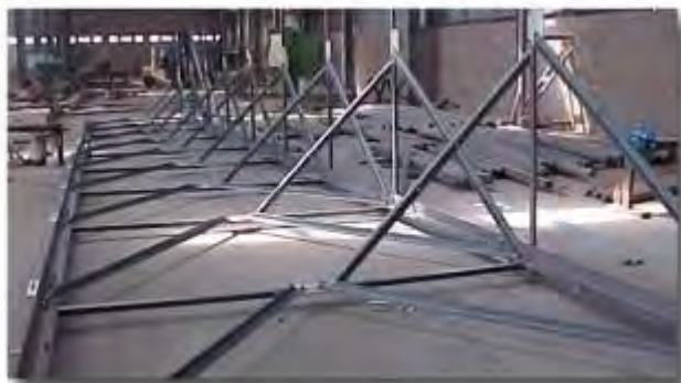
Os protótipos são fabricados e aprovados – Torre angular treliçada para BTS de topo de edifício
