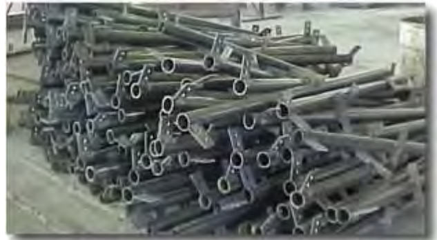
Tubos para montar antenas
