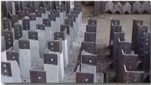
Bases de sustento soldadas prontas a Galvanizar
