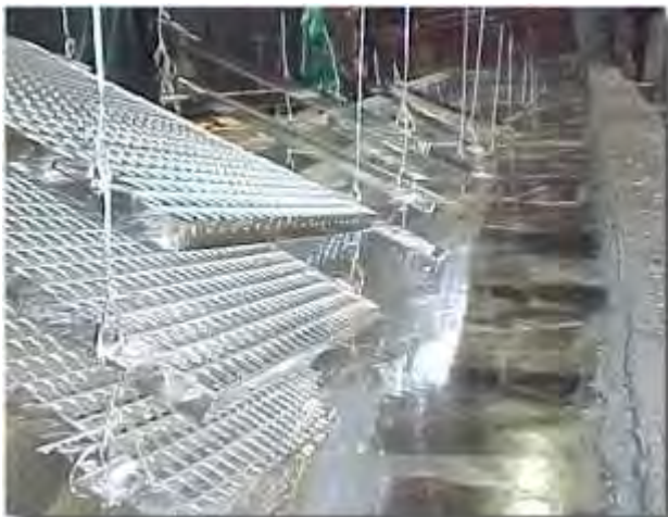
Todas as peças são galvanizadas a quente
